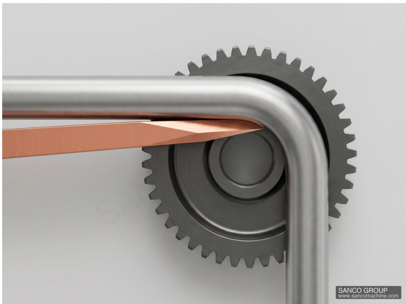
Figura 4 Diagrama Esquemático de la Posición de la Matriz Alisadora de Cobre en el Dispositivo de Curvado por Tracción Rotatoria — © SANCO GROUP · www.sancomachine.com
