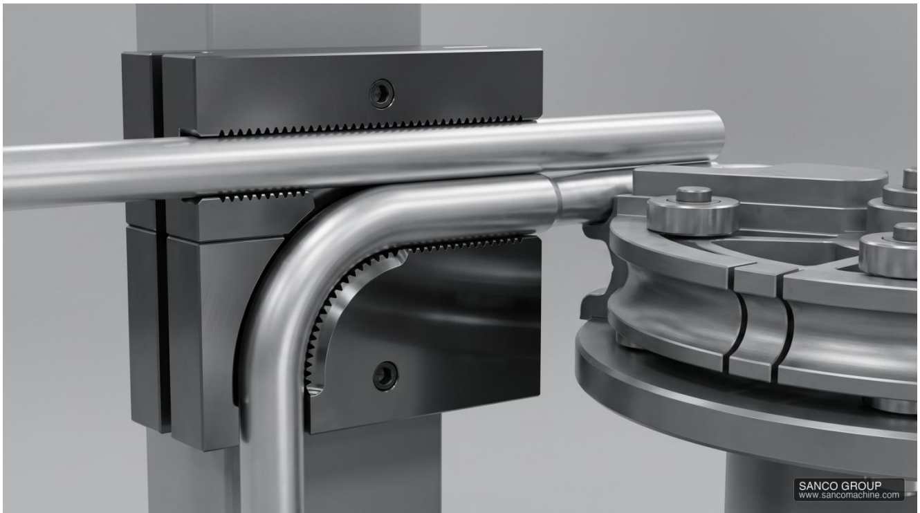
Figura 5 Diagrama Esquemático de la Matriz de Sujeción Conformada de Doble Capa (Dual-cavity Conformal Clamp Die) Sujetando una Pieza de Tubo de Sección Recta Corta ( L \approx 0 ) — —
