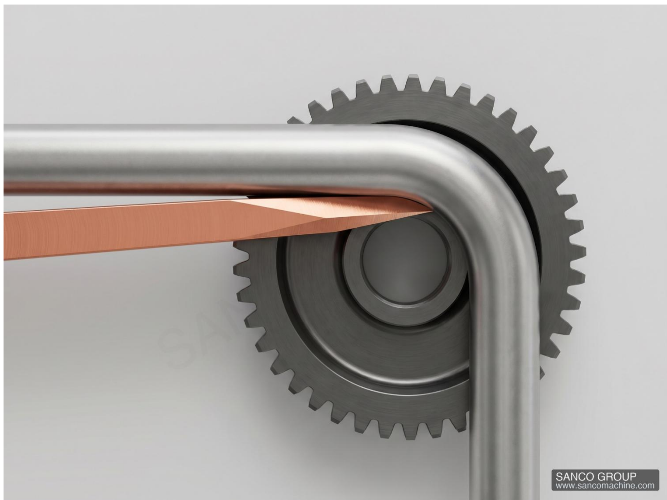
Рис. 4 Схема расположения медной разглаживающей планки (Wiper Die) в устройстве ротационной вытяжной гибки — © SANCO GROUP · www.sancomachine.com
