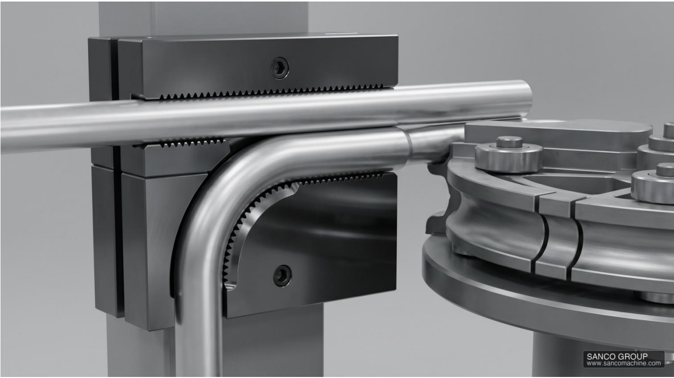
图5 双层仿形夹模（Dual-cavity Conformal Clamp Die）夹紧短直段（ L \approx 0 ）管件的工作示意 ——
